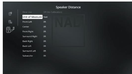
L’impostazione della distanza dei diffusori dell’impianto rappresenta un tocco finale sottile ma importante per la configurazione. Comunicando al T 778 le dimensioni degli altoparlanti all’ascoltatore di ciascun diffusore, si impostano automaticamente i corretti ritardi, l’ottimizzazione dell’immagine, della chiarezza e dell’atmosfera del suono surround. Inserire le dimensioni con precisione entro circa 30 cm.
