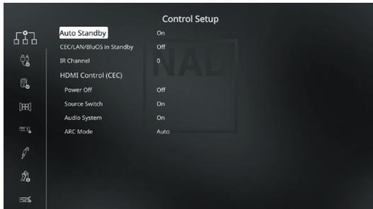
Il T 778 supporta le funzioni HDMI Control (Comando HDMI) e ARC (Audio Return Channel - Canale Audio di Ritorno). È possibile utilizzare entrambe le funzioni se i dispositivi esterni che le supportano entrambe sono interconnessi al T 778 tramite la connessione HDMI.
