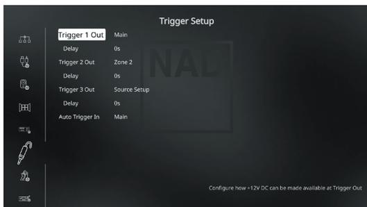
Il T 778 dispone di tre uscite trigger +12V DC configurabili che possono essere utilizzate per attivare un componente o un sistema in cui viene alimentato. Un'entrata Trigger è anche disponibile per attivare il collegamento applicabile a cui è associata.
