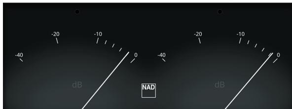
\*Il VU Meter monitora o riflette il livello audio della sorgente BluOS corrente. Se "Mute" (disattiva audio) è abilitato, il VU meter (misuratore di livello audio) non si spegnerà o andrà al livello minimo in quanto è l'uscita audio ad essere silenziata.
