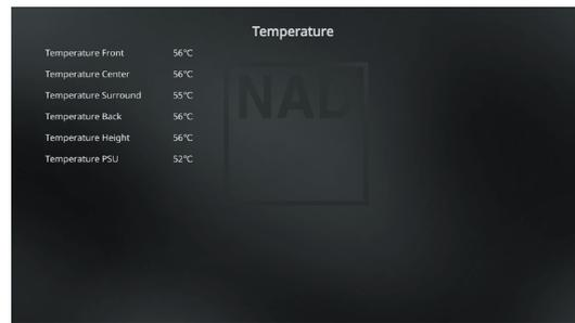
Le letture della temperatura sono visualizzate come misurate sui canali Front (anteriore), Center (centrale), Surround, Back (posteriore), Height (altezza) e PSU.
