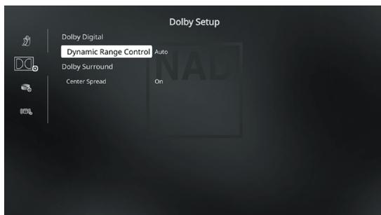
**Dynamic Range Control (Controllo gamma dinamica):** è possibile selezionare la gamma dinamica effettiva (gamma soggettiva da debole ad alta) per la riproduzione di colonne sonore Dolby Digital. Per ottenere un effetto completamente cinematografico, selezionare sempre 100%. Impostazioni del 75%, 50% e 25% riducono progressivamente la gamma dinamica, rendendo i suoni deboli relativamente più forti mentre limitano i picchi di livello sonoro di quelli alti.
