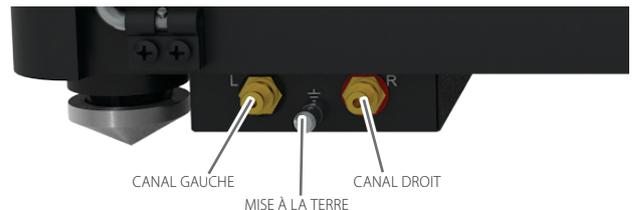
Si votre amplificateur n'a pas d'entrées acceptables pour les cellules de tourne-disque, vous avez besoin d'un amplificateur de tourne-disque distinct pour cellules MM ou MC qui est alors connecté entre le tourne-disque et une entrée de niveau ligne libre de l'amplificateur.
