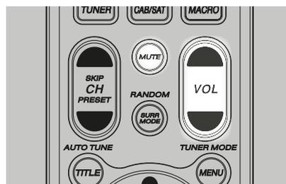
Oltre alla manopola del Volume, utilizzare il tasto [VOL ▲/▼] dell'HTR 8 per regolare il "volume master" del T 777 aumentando o diminuendo i canali nel loro insieme. Una pressione temporanea modifica il volume ad incrementi di 1 dB. Se si tiene premuto il tasto [VOL ▲/▼] la modifica del volume master continua ad andare avanti fino a che non si rilascia il tasto.
