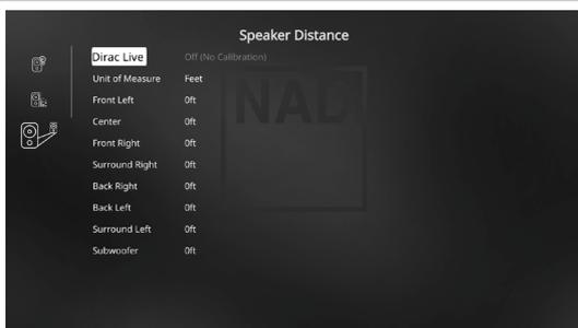
L'impostazione della distanza dei diffusori dell'impianto rappresenta un tocco finale sottile ma importante per la configurazione. Comunicando al T 777 le dimensioni dai diffusori all'ascoltatore di ciascun diffusore si impostano automaticamente i corretti ritardi, l'ottimizzazione dell'immagine, della chiarezza e dell'atmosfera del suono surround. Inserire le dimensioni con precisione entro circa 30 cm.
