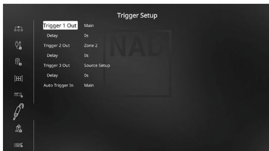
Il T 777 presenta tre uscite Trigger configurabili da +12V CC che si possono usare per attivare un componente o l'impianto in cui è alimentato. Un'entrata Trigger è anche disponibile per attivare il collegamento applicabile a cui è associata.
