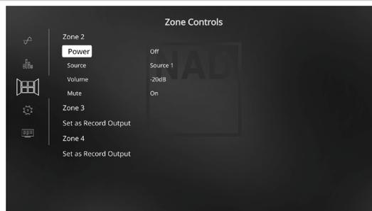
A seconda delle impostazioni realizzate nel menu "Zone Setup" (Impostazione Zona) a parte nella sezione "Setup Menu" (Menu Impostazione), è possibile configurare e gestire la Zona applicabile attraverso questa finestra "Zone Controls" (Controlli di Zona).
