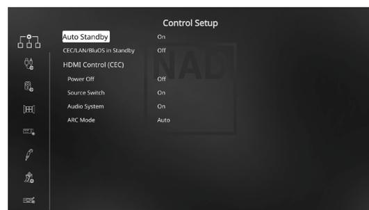
T 758 supporta le funzioni HDMI Control (Comando HDMI) e ARC (Audio Return Channel, Canale ritorno audio). È possibile utilizzare entrambe le funzioni se i dispositivi esterni che le supportano entrambe sono interconnessi a T 758 tramite la connessione HDMI.
