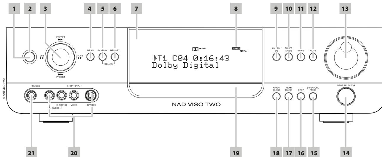
**1 BOUTON MARCHE/ARRÊT (POWER):** appuyez sur ce bouton ou sur le bouton MARCHÉ [ON] de la télécommande HTR 6 pour mettre le VISO TWO en marche. La LED témoin de Veille passera de l'orange au bleu et l'Affichage Vide-Fluorescent (VFD) s'allumera sur la face parlante. Une nouvelle impulsion sur le bouton de marche remet l'appareil en mode veille.
