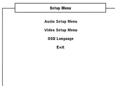
Pour tous les modes de source, appuyez sur le bouton [SETUP] de la télécommande HTR 6 pour que le menu de configuration apparaisse à l'écran. À l'aide des boutons de navigation de la télécommande, vous pouvez choisir entre les différents menus. Si le menu de configuration ne s'affiche pas, vérifiez les connexions vidéo applicables.
