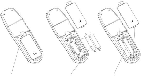
Прижмите и приподнимите выступ, чтобы вынуть крышку корпуса для батареек из углубления.
