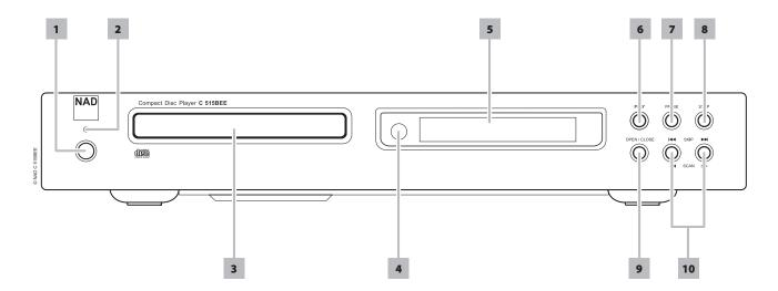
1 POWER ("CETЬ"): Нажмите эту кнопку или кнопку ON на пульте CD 7, чтобы включить устройство. Цвет индикатора режима ожидания сменится с желтого на синий. При повторном нажатии кнопки C 515BEE снова выключается в режим ожидания.
