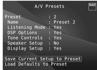
Enquanto estiver na linha do menu "Save Current Setup to Preset" (Guardar a Configuração Actual na Programação), utilize [D] para guardar as definições acima em Preset 2. Se aceder a "Preset 2" através do controlo remoto (para AVR 4, "A/V PSET" + "2"), os valores acima atribuídos a "Preset 2" (definições programadas conforme os OSD no passo 4) são seleccionados e activados para a fonte actual.
