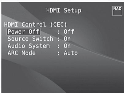
O T 757 suporta as funções de HDMI Control (CEC) (Controlo HDMI) e Audio Return Channel (ARC) (Canal de retorno de áudio). É possível utilizar ambas as funções, se dispositivos externos que sejam compatíveis com ambas as funções estiverem ligados ao T 757 através de HDMI.
