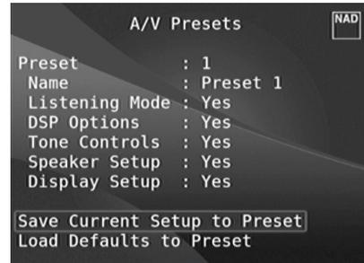
Enquanto estiver na linha do menu "Save Current Setup to Preset" (Guardar a Configuração Actual na Programação), utilize [D] para guardar as definições acima em Preset 1. É apresentado o OSD em baixo, para indicar que as definições acima foram guardadas em "Preset 1".
