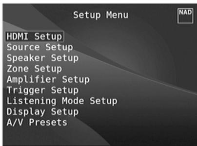
O Setup Menu permite ao utilizador personalizar o funcionamento do T 757 para o equipamento auxiliar utilizado no seu sistema A/V específico. A menos que o seu sistema corresponda exactamente às predefinições de fábrica como apresentado no Guia de Iniciação Rápida anexo, terá de utilizar o menu de configuração para configurar as entradas do T 757.
