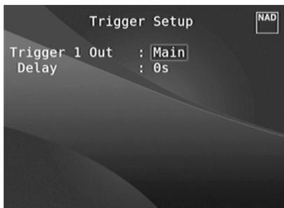
O T 757 dispõe de uma saída +12V TRIGGER OUT configurável, que pode ser utilizada para activar um componente ou sistema ao qual esteja ligado. É utilizada para ligar/desligar outros dispositivos compatíveis.
