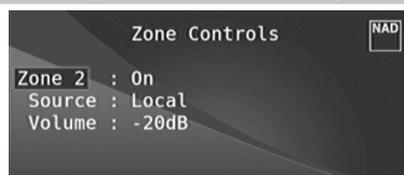
Consoante as definições efectuadas no menu separado "Zone Setup" (Configuração de zona) na secção "Setup Menu", a opção Zone 2 pode ser configurada e gerida através desta janela "Zone Controls" (Controlos de zona).
