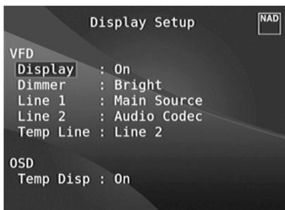
É possível apresentar o Visor fluorescente de vácuo (VFD) e a Indicação no visor (OSD) de várias formas ao navegar através dos parâmetros no menu Display Setup (Configuração do visor). Utilize uma combinação das teclas [◀/▶] ou [ENTER] e [▲/▼] para percorrer os itens do menu Display Setup.
