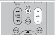
Oltre alla manopola del Volume, usare il tasto VOL  $[\blacktriangle/\blacktriangledown]$  del AVR 4 per regolare il "volume master" del T 757 aumentando o diminuendo i canali nel loro insieme. Una pressione temporanea modifica il volume master ad incrementi di 1 dB. Se si tiene premuto il tasto VOL  $[\blacktriangle/\blacktriangledown]$  la modifica del volume master continua ad andare avanti fino a che non si rilascia il tasto.
