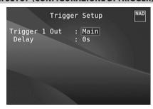
Il T 757 offre una uscita +12V DC Trigger configurabile che può essere utilizzata per attivare un componente o sistema da alimentare. Un'entrata Trigger è anche disponibile per attivareil collegamento applicabile a cui è associata.
