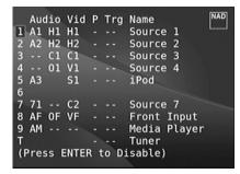
riepilogate e visualizzare sotto forma di tabella in Source Setup (Table View). Navigando attraverso Source Setup (Table View) mediante una combinazione di [¶/▶] e poi dei tasti [♠/♥], si potrà modificare direttamente le impostazioni per Audio, Video, Preset, Trigger e Source Name senza dover tornare al menu Source Setup (Normal View).
