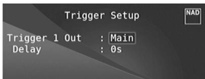
Das T 757 verfügt über einen konfigurierbaren +12V DC Trigger-Ausgang, der zur Aktivierung einer Komponente oder eines Systems verwendet werden kann, in die/das es gespeist wird. Es ist auch ein Triggereingang vorhanden, mit dem die zugeordnete Verbindung aktiviert werden kann.
