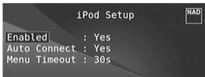
Im Menü „iPod Setup“ können Sie für den aktiven Eingang iPod die folgenden Einstellungen konfigurieren:
