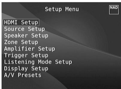
Im „Setup Menu“ kann der Betrieb des T 757 auf die Geräte in einem eigenen AV-System angepaßt werden. Wenn Ihr System nicht genau den in der mitgelieferten Kurzanleitung aufgeführten Werkseinstellungen entspricht, müssen Sie die Eingänge im „Setup Menu“ des T 757 konfigurieren.
