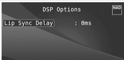
Zu den DSP-Optionen gehört die Funktion „Lip Sync Delay“ (Bild/Ton-Synchronisation), mit der Bild/Ton-Synchronisationsstörungen ausgeglichen werden können.
