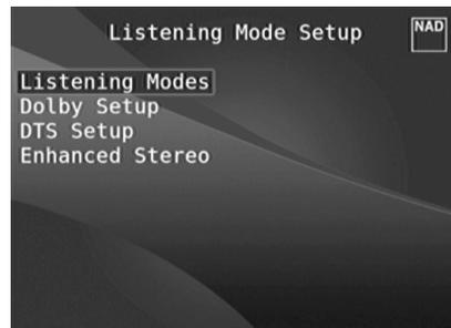
Der T 757 verfügt über verschiedene Hörmodi, die in einem weiten Bereich konfigurierbar sind. Mit diesen Hörmodi kann eine Vielzahl von Klangeffekten ganz nach dem Wiedergabematerial reproduziert werden. Konfigurieren Sie mit den Tasten [ ▲/▼ ] und [ ENTER ] die folgenden Einstellungen.
