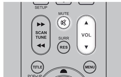
Zusätzlich zum Lautstärkeregel können die Tasten VOL [▲/▼] der Fernbedienung AVR 4 verwendet werden, um die Lautstärke des T 757 einzustellen. Hierbei werden die gesamten Kanäle lauter oder leiser gestellt. Ein kurzzeitiger Tastendruck ändert die Lautstärke in Schritten von 1 dB. Wenn Sie die Tasten VOL [▲/▼] gedrückt halten, läuft die Lautstärkeregelung weiter, bis die Taste freigegeben wird.
