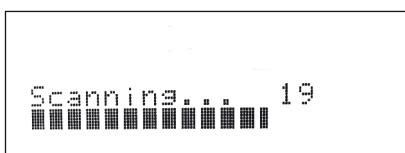
Полоски на экране служат для индикации процесса. После того, как сканирование завершено, последнее число, отображаемое на дисплее соответствует общему числу обнаруженных радиовещательных станций DAB. Затем происходит настройка на первую станцию (см. раздел "Алфавитно-цифровой порядок" ниже, чтобы разобраться в порядке и расположении станций).
