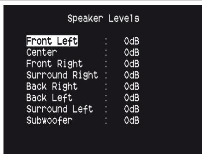
Регулировка баланса акустических систем, подключенных к вашему ресиверу, обеспечивает при воспроизведении любой записи, будь то музыка или фильм, такую звуковую картину, сбалансированность эффектов, музыки и диалогов, которая была задумана изначально. Кроме того, если к ресиверу подключен сабвуфер, регулировка баланса позволяет добиться правильно соотношения уровня громкости сабвуфера и других акустических систем, и, соответственно, низких частот с другими звуковыми элементами.
