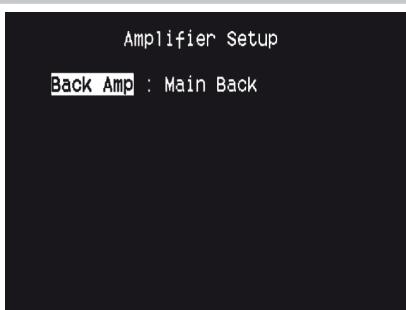
Если тыловые акустические системы окружающего звука не используются в основной зоне, то каналы их усилителя могут быть назначены для тылового канала основной зоны (Main Back), фронтального канала основной зоны (Bi-Amp) и Зона 2 (Zone 2) использования.
