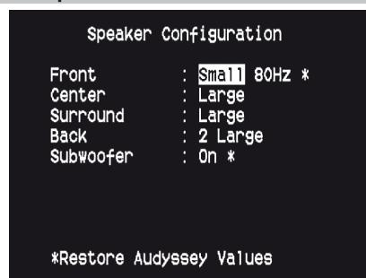
Любая система объемного звука нуждается в "управлении низкими частотами" для направления низкочастотных сигналов нескольких или всех каналов на акустические системы, способные наилучшим образом воспроизвести их. Для корректной работы этой функции важно точно определить возможности акустических систем. Мы используем термины Small ("Малая") и Large ("Большая") (а также опция Off – "отсутствующая"), но имейте в виду, что физический размер может не соответствовать техническим возможностям.
