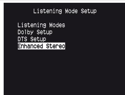
Ресивер T 757 предусматривает различные варианты прослушивания, большинство из которых конфигурируемые. Режимы предназначены для обработки звука различными эффектами в зависимости от воспроизводимого источника. Конфигурирование выполняется с помощью кнопок [**◀/▶**] или ENTER и [**▲/▼**].
