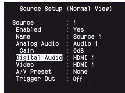
Для выбора нужного цифрового аудиовхода для конкретного источника перейдите к пункту Digital Audio, нажмите кнопку [D], а затем [ $\Delta/\nabla$ ]. Определившись с выбором входа, нажмите [D], а затем снова [ $\Delta/\nabla$ ] для выбора конкретного цифрового аудиовхода.
