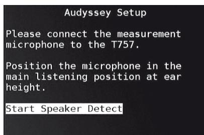
запоминаются ресивером. Настройка может занять некоторое время, в зависимости от количества акустических систем. После проведения измерений во всех позициях функция Audyssey рассчитывает идеальную частотную характеристику для конкретного помещения и конфигурации акустических систем.
