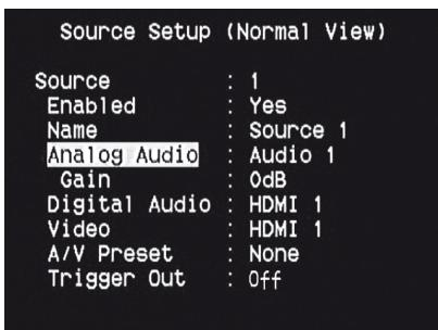
Перейдите к пункту Analog Audio и нажмите кнопку [D], а затем [ $\Delta/\nabla$ ] для выбора и назначения аналогового входа конкретному источнику. Предлагается три опции – Audio, 7.1 Input или OFF (“Выкл.”).
