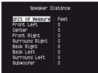
Определение расстояния до ваших акустических систем является незаметным, но чрезвычайно важным параметром настройки вашей системы. Если вы в настройках ресивера T 757 укажите расстояние от каждой акустической системы до места прослушивания, это позволит ресиверу автоматически определить правильное время задержки сигнала, оптимизировать звуковую картину, четкость воспроизведения и точность пространственной атмосферы. Расстояние следует вводить с точностью до 1 фута (30 см).
