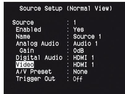
Для выбора нужного видеовхода нажмите кнопку [D], а затем [ $\Delta/\nabla$ ] для переключения между опциями. Могут назначаться следующие видеовходы:
