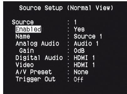
С помощью этой опции можно включить или отключить источник. Это нужно, в частности, когда количество подключенных источников невелико, и пользователь может выбрать источник напрямую с помощью кнопок на лицевой панели, пропуская неиспользуемые источники.
