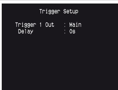
В Т 757 имеется настраиваемый вывод +12 В постоянного тока, который можно использовать для активации компонента или системы, к которой он подключен. Триггеры представляют собой низковольтные сигналы, используемые для включения-выключения совместимых устройств.
