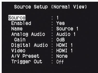
Ресивер T 757 предусматривает десять конфигурируемых источников. Настройки каждого источника зависят от набора параметров, установленного для окна данного конкретного источника.
