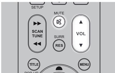
Zusätzlich zum Lautstärkereglern können die Tasten VOL [▲/▼] der Fernbedienung AVR 4 verwendet werden, um die Lautstärke des T 757 einzustellen. Hierbei werden die gesamten Kanäle lauter oder leiser gestellt. Ein kurzzeitiger Tastendruck ändert die Lautstärke in Schritten von 1 dB. Wenn Sie die Tasten VOL [▲/▼] gedrückt halten, läuft die Lautstärkeregelung weiter, bis die Taste freigegeben wird.
