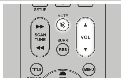
Кроме ручки громкости на лицевой панели общий уровень громкости ресивера T 748 также регулируется кнопками VOL **▲/▼** пульта ДУ AVR 4, при этом повышение и понижение уровней каналов происходит для обоих каналов одновременно. При однократном нажатии на кнопку уровень громкости
