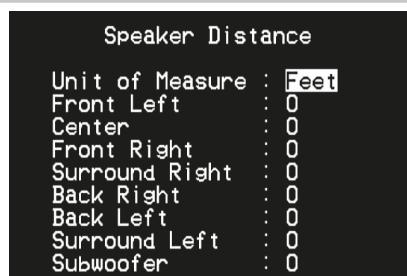
Определение расстояния до ваших акустических систем является незаметным, но чрезвычайно важным параметром настройки вашей системы. Если вы в настройках ресивера T 748 укажите расстояние от каждой акустической системы до места прослушивания, это позволит ресиверу автоматически определить правильное время задержки сигнала, оптимизировать звуковую картину, четкость воспроизведения и точность пространственной атмосферы. Расстояние следует вводить с точностью до 1 фута (30 см).
