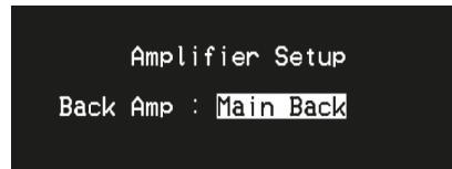
Если тыловые акустические системы окружающего звука не используются в основной зоне, то каналы их усилителя могут быть назначены для тылового канала основной зоны (Main Back), фронтального канала основной зоны (Bi-Amp) и Зона 2 (Zone 2) использования.
