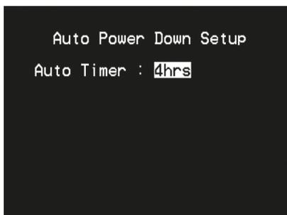
T 748 можно настроить для автоматического перехода в режим ожидания при отсутствии действий пользователя в течение заданного времени. Установите для параметра Auto Timer (Автоматический таймер) предпочитаемое время.
