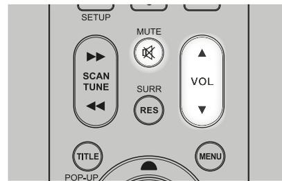
Кроме ручки громкости на лицевой панели общий уровень громкости ресивера Т 765 также регулируется кнопками VOL ▲/▼ пульта ДУ AVR 4, при этом повышение и понижение уровней каналов происходит для обоих каналов одновременно. При однократном нажатии на кнопку уровень громкости изменяется на 1 дБ. Если удерживать кнопки VOL ▲/▼ в нажатом положении, уровень будет меняться непрерывно до тех пор, пока Вы не отпустите кнопку.
