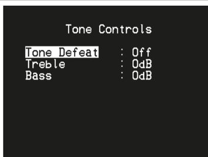
Ресивер Т 748 имеет два регулятора тембра – Treble (Высокие частоты) и Bass (Низкие частоты). Регуляторы Bass и Treble затрагивают только низкие частоты нижнего диапазона и высокие частоты верхнего диапазона, оставляя важные средние частоты без изменения.
