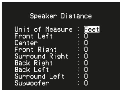
Определение расстояния до ваших акустических систем является незаметным, но чрезвычайно важным параметром настройки вашей системы. Если вы в настройках ресивера Т 748 укажете расстояние от каждой акустической системы до места прослушивания, это позволит ресиверу автоматически определить правильное время задержки сигнала, оптимизировать звуковую картину, четкость воспроизведения и точность пространственной атмосферы. Расстояние следует вводить с точностью до 1 фута (30 см).
