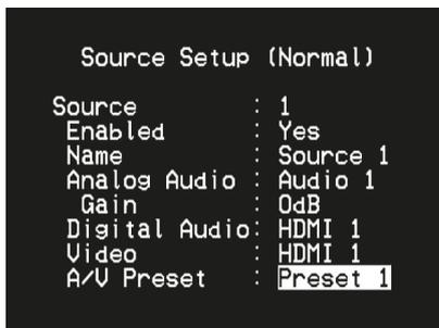
В примере выше набор установок Preset 1 назначен для источника Source 1. При подключении источника Source 1 автоматически применяются настройки набора установок Preset 1. Вы можете изменить назначение набора установок для источника вручную с помощью соответствующих кнопок пульта дистанционного управления.
