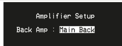
Если тыловые акустические системы окружающего звука не используются в основной зоне, то каналы их усилителя могут быть назначены для тылового канала основной зоны, фронтального канала основной зоны (Bi-Amp) и мультizonного использования.
