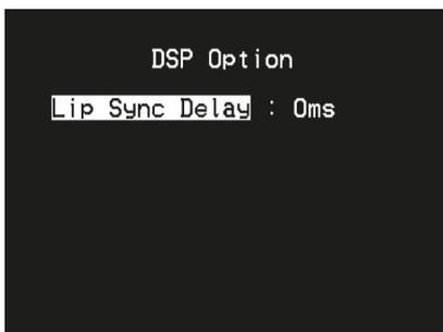
As DSP Options incluem uma funcionalidade de "Lip Sync Delay" (Atraso de sincronização de lábios), que permite fazer coincidir qualquer atraso que possa ocorrer no filme relativamente ao som.
