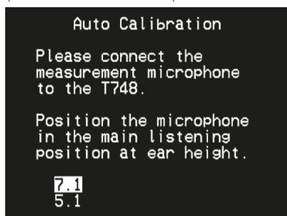
O som na sua posição de audição principal é configurado através do microfone Audyssey fornecido. Dependendo do número de altifalantes, pode seleccionar a configuração de 7.1 ou 5.1 canais. Após seleccionar 7.1 ou 5.1 canais, a calibração automática é iniciada – consulte o OSD à medida que a calibração automática configura cada um dos parâmetros.
