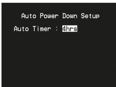
O T 748 pode ser configurado para entrar automaticamente no modo de espera, se não existir interação da interface de utilizador no período de tempo atribuído. Defina "Auto Timer" (Temporizador automático) para um período preferencial.
