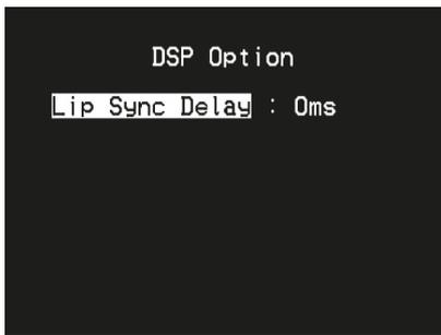
Zu den DSP-Optionen gehört die Funktion „Lip Sync Delay“ (Bild/Ton-Synchronisation), mit der Bild/Ton-Synchronisationsstörungen ausgeglichen werden können.
