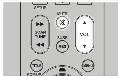
Zusätzlich zum Lautstärkeregler können die Tasten VOL [▲/▼] der Fernbedienung AVR 4 verwendet werden, um die Lautstärke des T 748 einzustellen. Hierbei werden die gesamten Kanäle lauter oder leiser gestellt. Ein kurzzeitiger Tastendruck ändert die Lautstärke in Schritten von 1 dB. Wenn Sie die Tasten VOL [▲/▼] gedrückt halten, läuft die Lautstärkeregelung weiter, bis die Taste freigegeben wird.
