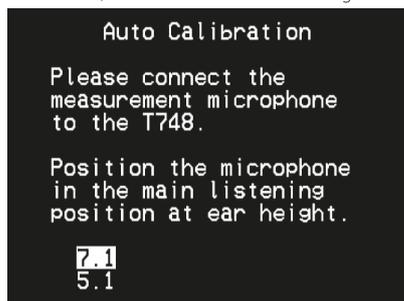
Der Sound an Ihrer primären Hörposition wird mithilfe des mitgelieferten Mikrofons eingerichtet. Je nach verfügbaren Lautsprechern können Sie entweder die 7.1- oder 5.1-Einstellung wählen. Nach der Wahl von 7.1 oder 5.1 startet die automatische Kalibrierung. Beziehen Sie sich auf das Bildschirmmenü, während die automatische Kalibrierung die einzelnen Messparameter durchläuft.
