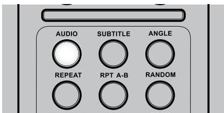
Ist die eingelegte DVD mit der Audio-Formatfunktion kompatibel, kann über die Taste [AUDIO] auf die Audioformateinstellung zugegriffen werden.
