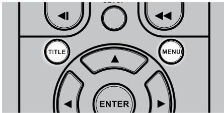
Diese beiden Tasten befinden sich lediglich auf der Fernbedienung. Sie werden verwendet, um die Titel und Menüs von DVDs und weiteren kompatiblen Disks auf dem Bildschirm anzuzeigen.
