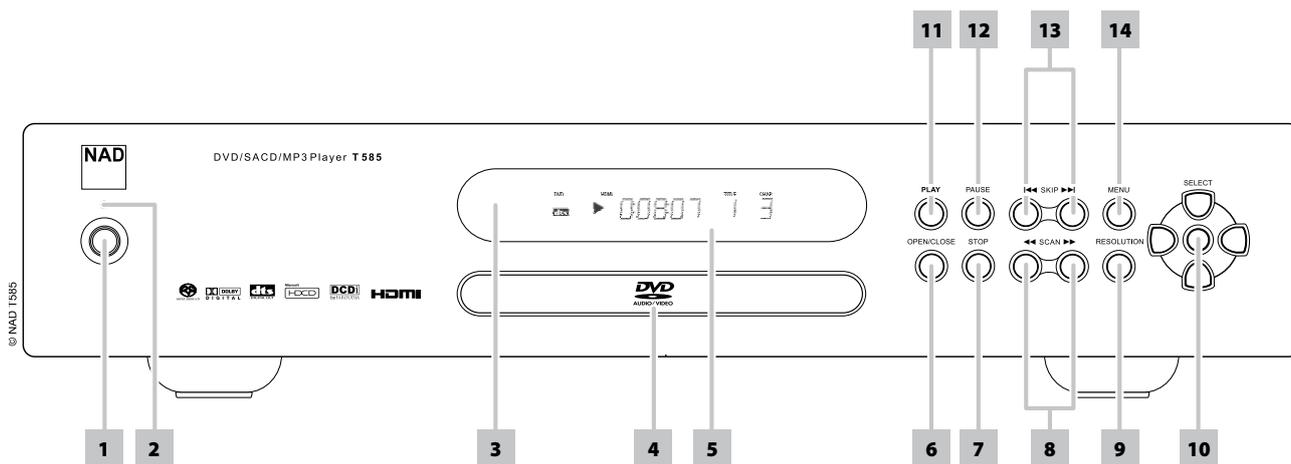
**1 BETRIEBSSCHALTER:** Drücken Sie diese Taste, um den T 585 einzuschalten. Die LED für die Bereitschaftsanzeige schaltet von gelb auf grün um und das VFD-Anzeigefeld leuchtet auf. Durch erneutes Drücken des Netzschalters wird das Gerät wieder in den Bereitschaftsmodus versetzt. Der T 585 kann auch aus dem Bereitschaftsmodus eingeschaltet werden, indem Sie die Taste [OPEN/CLOSE] oder die [PLAY]-Taste an der Frontplatte bzw. auf der Fernbedienung drücken.
