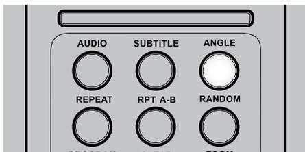
Manche DVDs enthalten Szenen, die gleichzeitig von mehreren verschiedenen Aufnahmewinkeln aus aufgenommen worden sind. Mit der Taste ANGLE kann bei solchen Discs dieselbe Szene von jedem dieser Aufnahmewinkel aus wiedergegeben werden. Diese Funktion arbeitet nur bei Discs, die Szenen mit verschiedenen Aufnahmewinkeln enthalten.
