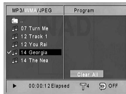
Mit dem T 585 können als MP3- oder WMA-Dateien formatierte Aufnahmen von CD-Rs oder CD-RWs wiedergegeben und Disks mit JPEG-Dateien angezeigt werden. Auf einer Disk können sich mehrere Dateitypen befinden.
