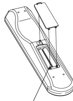
Batteriefachdeckel durch ausrichten und einführen in die aussparungen wieder einsetzen. Batteriefachdeckel hineindrücken bis er mit einem hörbaren klick schliesst.
