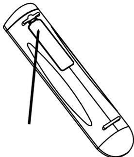
按下并提起凸片即可将置于凹处的电池盖打开
