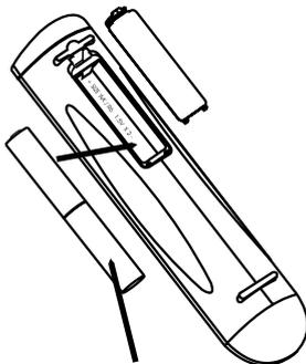
将电池放入电池仓。确保电池极性的方向正确。
