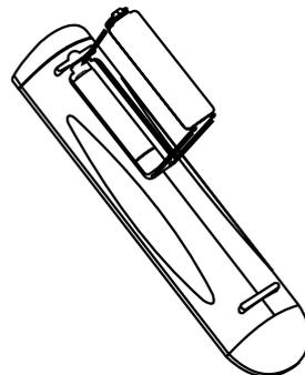
将电池盖对准电池仓并将两个凸片插入相应孔内，按下电池盖直到完全盖住原位（听到喀哒一声）。
