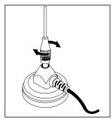
2 Enchufe el conector de la antena al terminal de antena DAB del M4.
