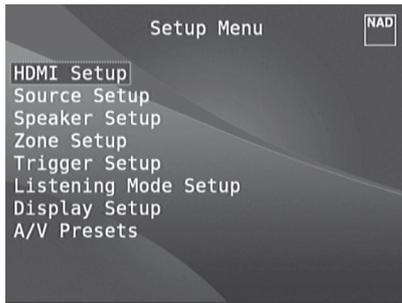
Меню настройки позволяет пользователю настроить предусилитель M15 HD для работы в составе конкретной аудио-видеосистемы. С помощью данного меню Вам нужно будет произвести настройку входных разъемов предусилителя, если, конечно, Ваша система не соответствует заводским настройкам, описанным в прилагающемся Руководстве по быстрому запуску, полностью.
