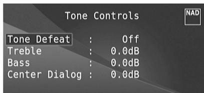
Предусилитель M15 HD имеет три регулятора тембра – Treble ("Высокие частоты"), Bass ("Низкие частоты") и Center Dialog ("Баланс средних частот"). Регуляторы Bass и Treble затрагивают только низкие частоты нижнего диапазона и высокие частоты верхнего диапазона, оставляя важные средние частоты без изменения. Регулятор Center Dialog увеличивает "присутствие" среднего диапазона, делая воспроизведение речи более внятным.
