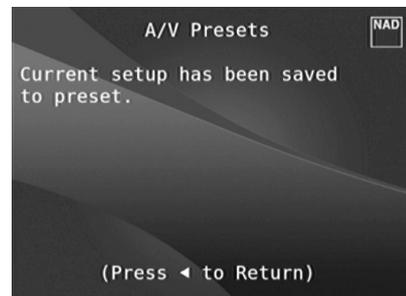
Wenn Sie „Preset 1“ (Voreinstellung 1) über die Fernbedienung abrufen (bei AVR 4: „A/V PSET“ + „1“), werden die obigen Voreinstellungswerte unter „Preset 1“ (Voreinstellung 1) (Voreinstellungen wie in den Bildschirmmenüanzeigen in Schritt 1 abgebildet) abgerufen und auf die aktuelle Quelle angewandt.
