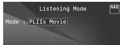
Der T 758 bietet verschiedene, auf bestimmte Aufnahmen oder Programm-Material zugeschnittene Hörmodi. Mit einer Zweikanal-Signalquelle (Stereo) können die folgenden Hörmodi ausgewählt werden:
