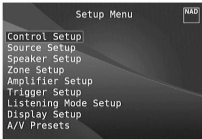
Im „Setup Menu“ kann der Betrieb des T 758 auf die Geräte in einem eigenen AV-System angepasst werden. Wenn Ihr System nicht genau den in der mitgelieferten Kurzanleitung aufgeführten Werkseinstellungen entspricht, müssen Sie die Eingänge im „Setup Menu“ des T 758 konfigurieren.
