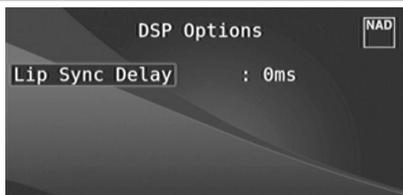
Zu den DSP-Optionen gehört die Funktion „Lip Sync Delay“ (Bild/Ton-Synchronisation), mit der Bild/Ton-Synchronisationsstörungen ausgeglichen werden können.
