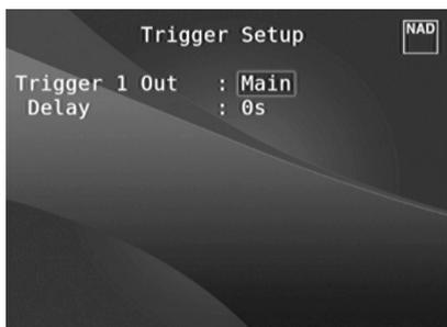
Das T 758 verfügt über einen konfigurierbaren +12V DC Trigger-Ausgang, der zur Aktivierung einer Komponente oder eines Systems verwendet werden kann, in die/das es gespeist wird. Es ist auch ein Triggereingang vorhanden, mit dem die zugeordnete Verbindung aktiviert werden kann.
