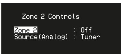
La función Zone permite escuchar simultáneamente en una distinta zona de la casa el audio seleccionado de cualquiera de las fuentes habilitadas y de Front, MP, iPod y Tuner.
