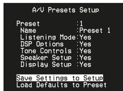
Teniendo resaltada la línea "Save Settings to Setup" (Guardar las configuraciones de Setup), pulse [►] para guardar los ajustes anteriores bajo Preset 1. Aparece la siguiente pantalla OSD para confirmar que dicha configuración fue guardada bajo "Preset 1".
