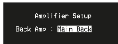
Si los altavoces envolventes traseros no se utilizan en la zona principal, sus correspondientes canales del amplificador envolvente trasero se pueden asignar para utilización Trasera Principal, Delantero Principal (Bi-amplificación) y de Zona 2.
