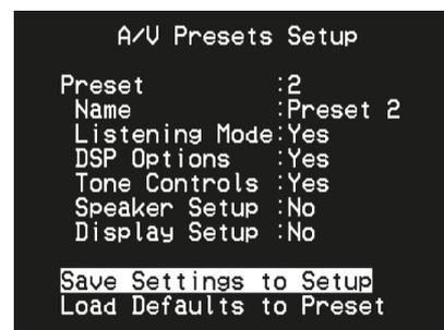
Teniendo resaltada la línea "Save Current Setup to Preset" (Guardar la actual configuración bajo el preajuste), pulse [►] para guardar los ajustes anteriores bajo Preset 2. Cuando selecciona "Preset 2" los valores anteriores guardados bajo "Preset 2" (la configuración del preajuste que se muestran en la OSD en el Paso 4) son activados y afectan la fuente actual.
