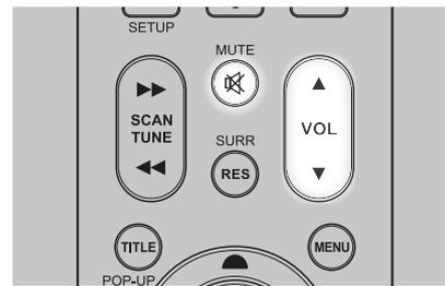
Además del botón de Volumen, puede utilizar las teclas de VOL ▲/▼ del AVR 4 para ajustar el "volumen principal" del T 748, aumentando o disminuyendo todos los canales. Si pulsa momentáneamente la tecla, el volumen principal cambiará en incrementos de 1 dB. Si mantiene pulsada la tecla de VOL ▲/▼, el cambio del volumen principal "proseguirá" hasta que se suelte la tecla.
