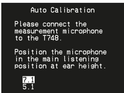
El sonido en su posición de escucha principal se calibra con el uso del micrófono suministrado. Dependiendo del número de altavoces, puede seleccionar la configuración de 7.1 ó 5.1. Después de seleccionar la configuración de 7.1 ó 5.1, la calibración se inicia – favor referirse a la pantalla OSD a medida que la autocalibración configura cada uno de los parámetros.
