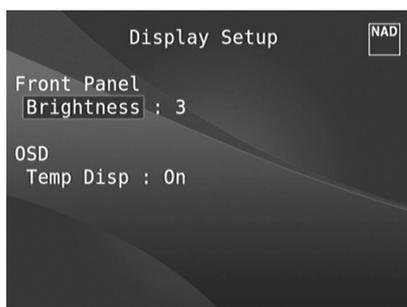
Меню Display Setup (Настройка дисплея) позволяет регулировать яркость дисплея на передней панели и доступность экранного меню.
