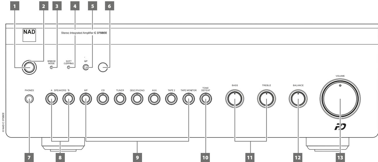
**1 STANDBY (ESPERA):** Pulse este botón para encender el C 375BEE (debe tener el interruptor POWER (Alimentación) en posición ON en el panel trasero). El indicador LED Standby (En espera) cambiará de ámbar a azul. Si se pulsa el botón STANDBY nuevamente la unidad vuelve a modo de espera.
